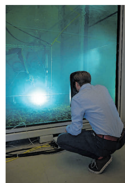
Durch eine Schweißmaske lässt sich der Prozess unter Wasser gut beobachten.
