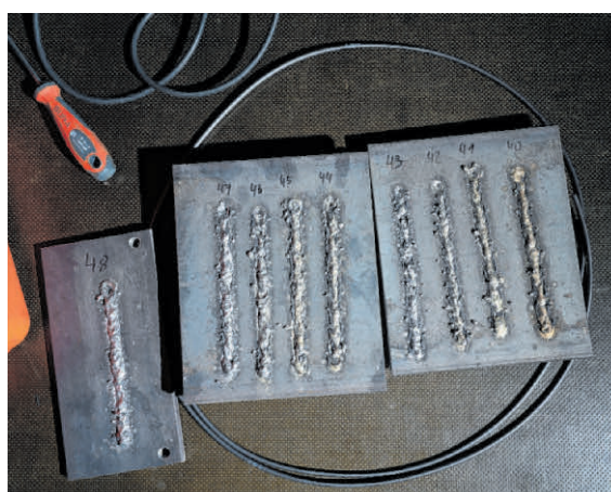
Zwischendurch prüfen die Forscher Schweißnaht und Drahtführung.
